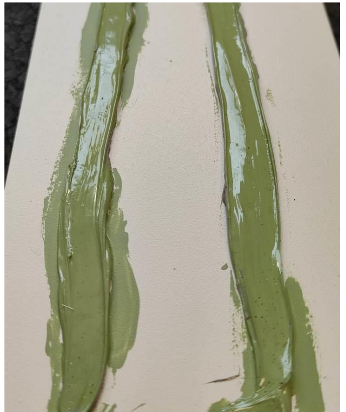
Figura 16 – 17: Risultati del test d'adesione del TouchUp Kit si silicone.
