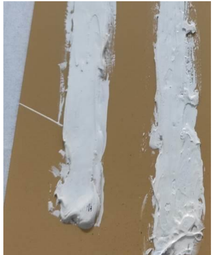
Figura 18 – 19: Risultati del test d'adesione TouchUp Kit su silicone
