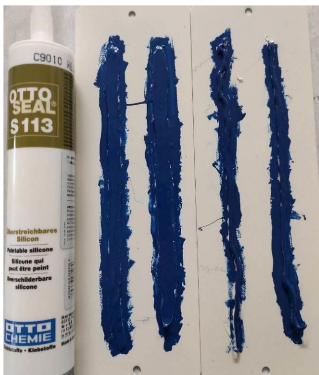
Figura 14 – 15: Risultati del test d'adesione TouchUp Kit su silicone
