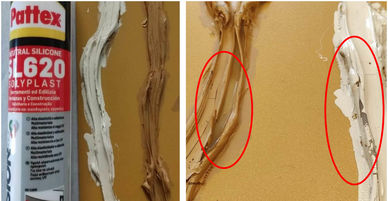
Figura 20-21: Distaccamento del TouchUp su silicone non verniciabile
