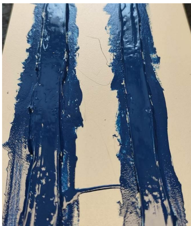
Figura 14 – 15: Risultati del test d'adesione TouchUp Kit su silicone
