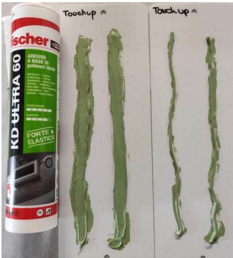
Figura 16 – 17: Risultati del test d'adesione del TouchUp Kit si silicone.
