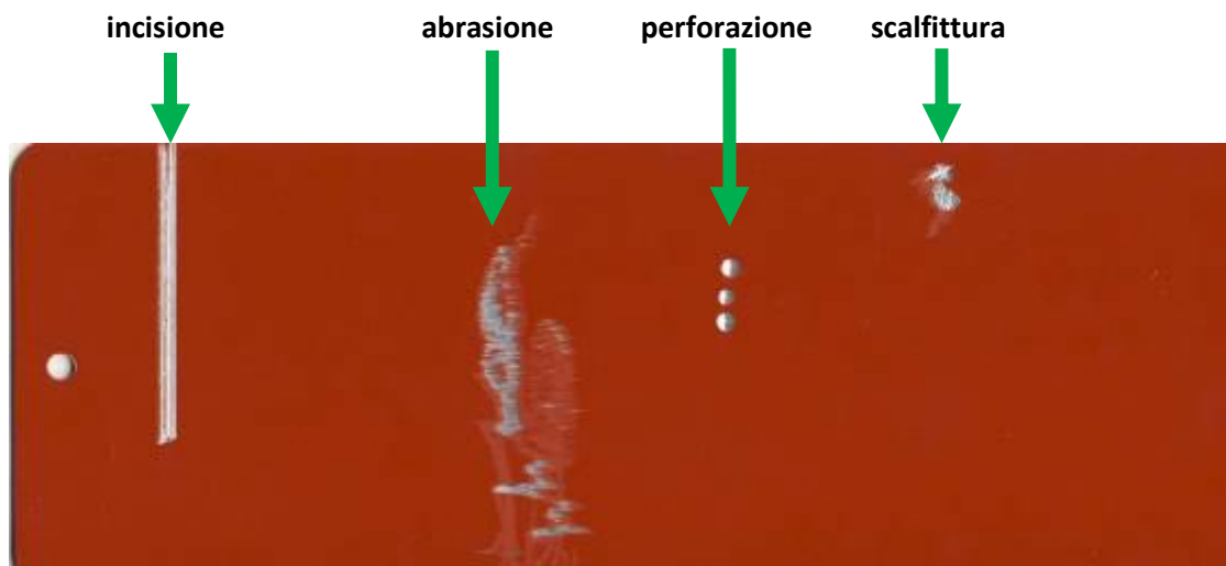
Figura 5: Lamierino danneggiato in profondità, con il metallo sottostante esposto
