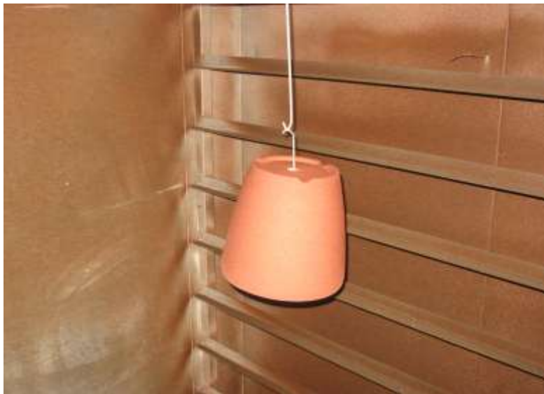
Figura 3: inserimento in forno, insieme al supporto, per completare la reticolazione
