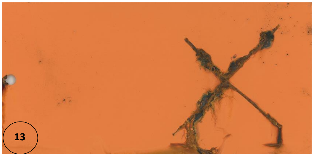
Figura 13: Lamierino sovraverniciato con tinta poliestere su Ironsafe-01 dopo il test della nebbia salina.
