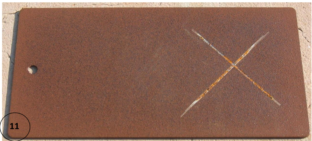
Figura 11: Lamierino sovraverniciato su Ironsafe-01 dopo il test dell'umidostato.
