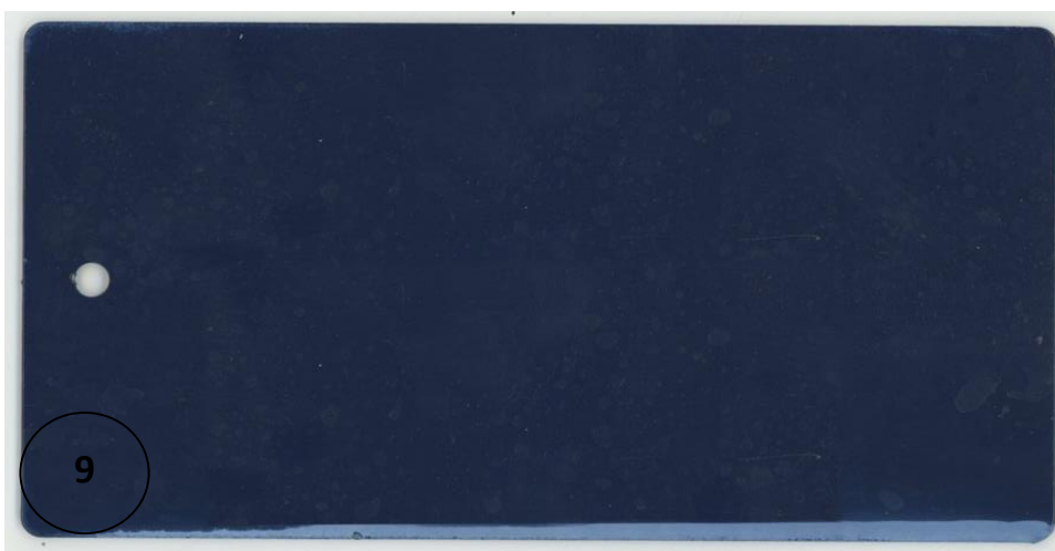
Figura 9: Lamierino sovraverniciato su Ironsafe-01 dopo il test di resistenza in pentola a pressione.
