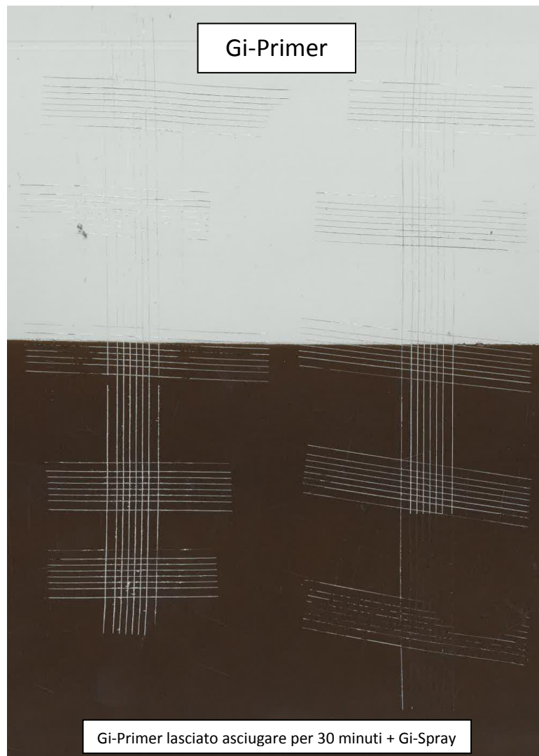
Figura 9: Prova d'adesione effettuata su lamierino con un alto spessore di Gi-Primer.
