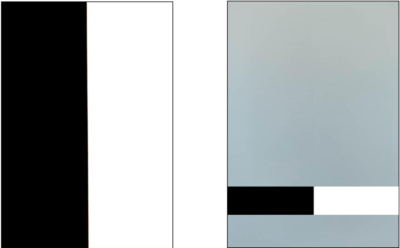
Figura 6-7: Risultato del test di coprenza a (SX) lamierino ad inizio test, (DX) lamierino a test concluso.
