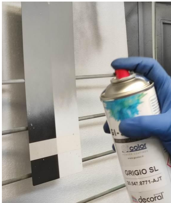
Figura 4 - 5: Differenti stadi della verniciatura del lamierino di prova.
