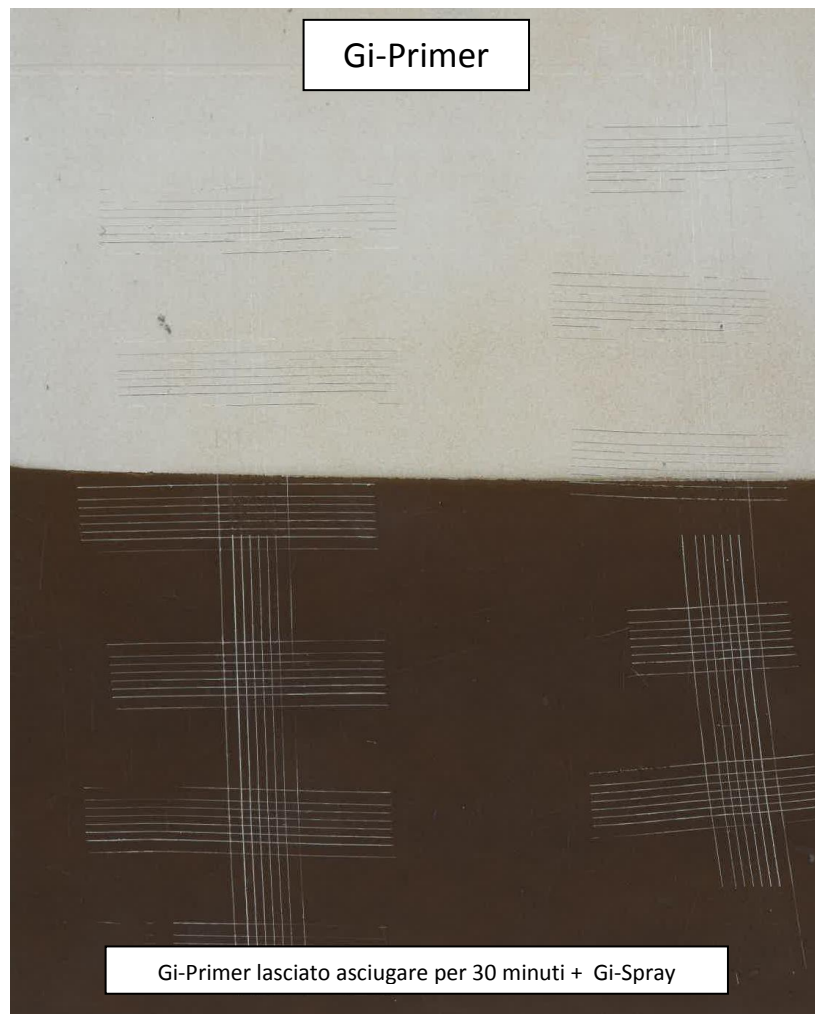
Figura 8: Prova d'adesione del Gi-Spray effettuata su lamierini con un basso spessore di Gi-Primer.
